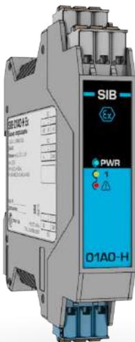
Изолирующий повторитель аналогового сигнала 0(4)...20 мА во взрывоопасную зону, «прозрачный» для двустороннего обмена по протоколу HART. Трехсторонняя изоляция вход/выход/питание. Индикация обрыва и короткого замыкания линии связи с исполнительным устройством, а также имитация данного отказа в виде обрыва линии связи с управляющим устройством.
