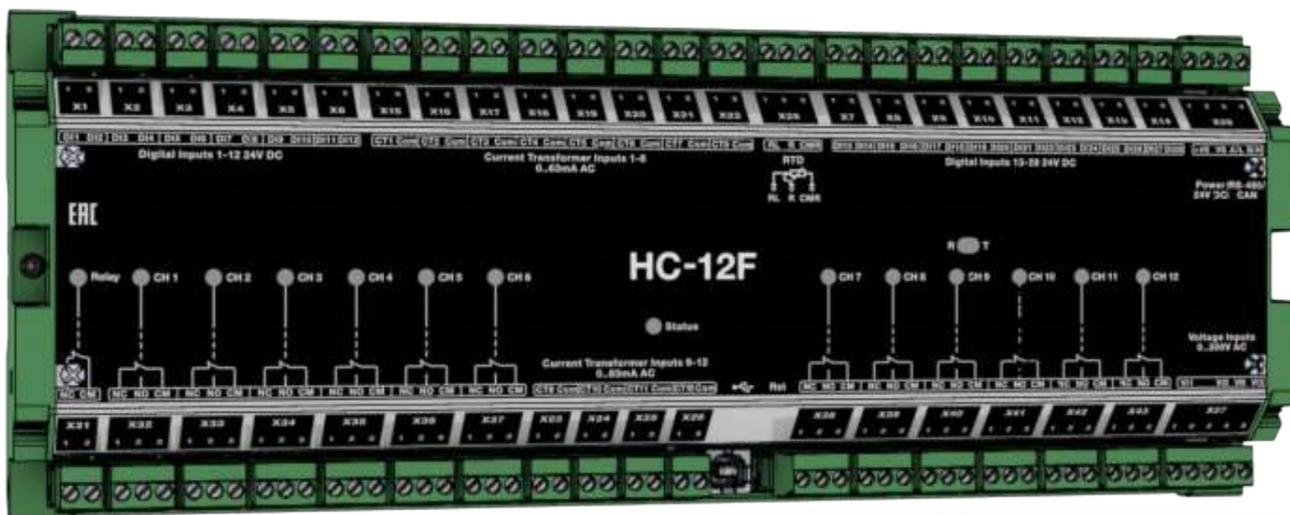
Устройство управления нагрузкой, предназначенное для автоматического и дистанционного дискретного управления питанием потребителей, измерения потребляемого ими тока (с помощью внешних измерительных трансформаторов), а также измерения напряжения по трём фазам.
